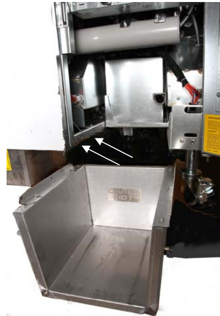
Afbeelding 1: Plaats de smelter in de behuizing en maak vast aan de binnenkant van de behuizing met de meegeleverde schroeven.
