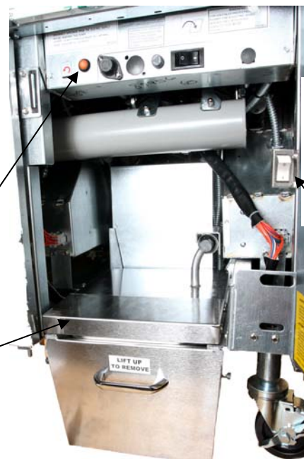
Afbeelding 3: Bevestig de twee-pens witte aansluitingen en steek de zwarte aansluiting in de doos zoals aangegeven.
