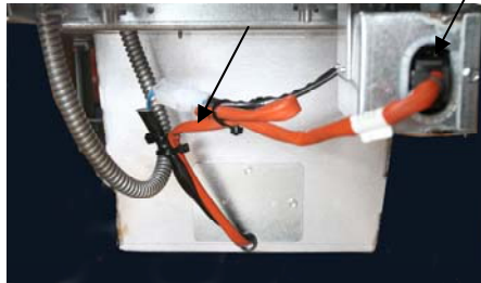
Afbeelding 3: Bevestig de twee-pens witte aansluitingen en steek de zwarte aansluiting in de doos zoals aangegeven.
